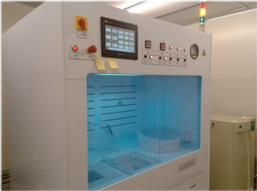
清洗的目的在于清除表面污染杂质，包括有机物和无机物。半导体兆声清洗系统所采用的是化学清洗。这对于微米及深亚微米超大规模集成电路的良率有着极大的影响。
