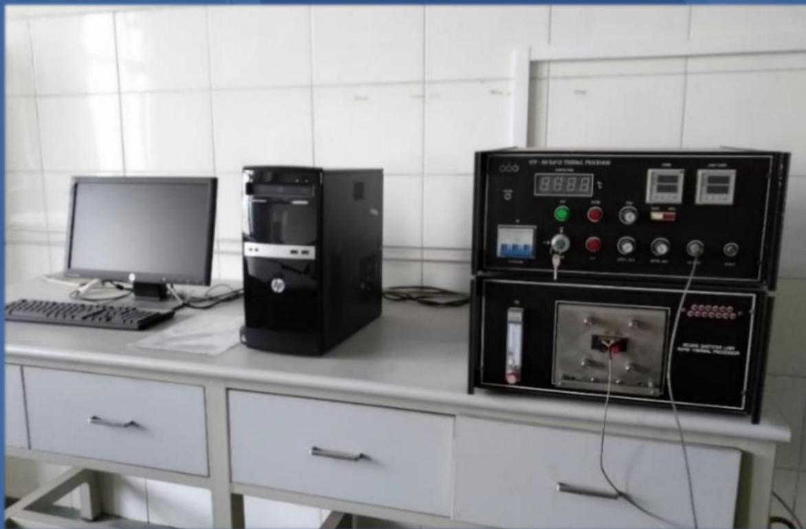
快速热退火是用各种热辐照源，直接照射在样品表面上，迅速将样品加热至 $700\sim 1200^{\circ}\text{C}$ 左右在几秒~几十秒的时间内完成退火。它可以使用较高的退火温度，这有利于提高注入杂质的激活率与迁移率，瞬态退火可以减少注入杂质的再分布，形成陡峭的杂质分布或突变结，另外当退火温度要求不十分高时，样品表面无须用介质膜保护，简化了工艺。
