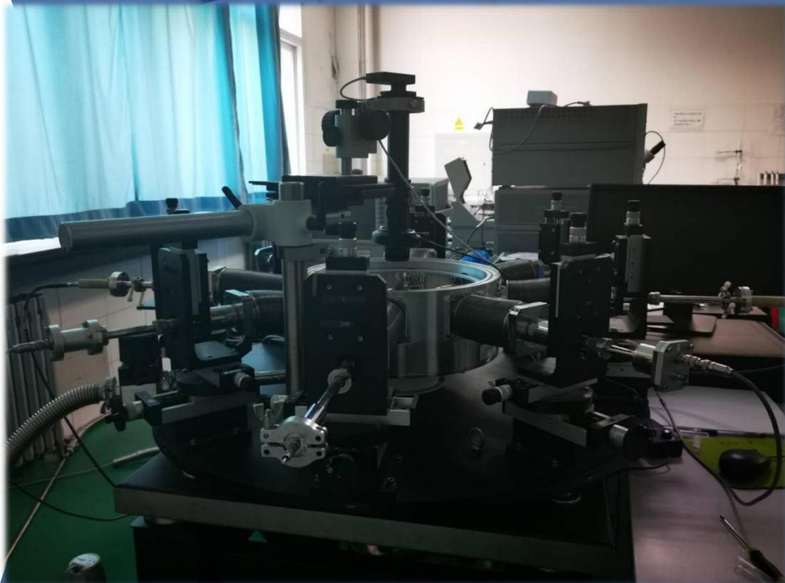
完整的低温真空探针台测试系统，广泛应用于半导体工业（芯片、晶圆片、封装器件）、MEMS、超导、电子学、铁电子学、物理学和材料学等领域。
