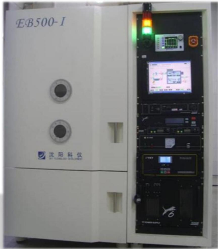
电子束蒸镀 (Electron Beam Evaporation) 是物理气相沉积的一种。与传统的蒸镀方式不同，电子束蒸镀是利用电磁场的配合可以精确地实现利用高能电子轰击坩埚内靶材，使之融化进而沉积在基片上，并且可以蒸镀出高纯度、高精度的薄膜。
