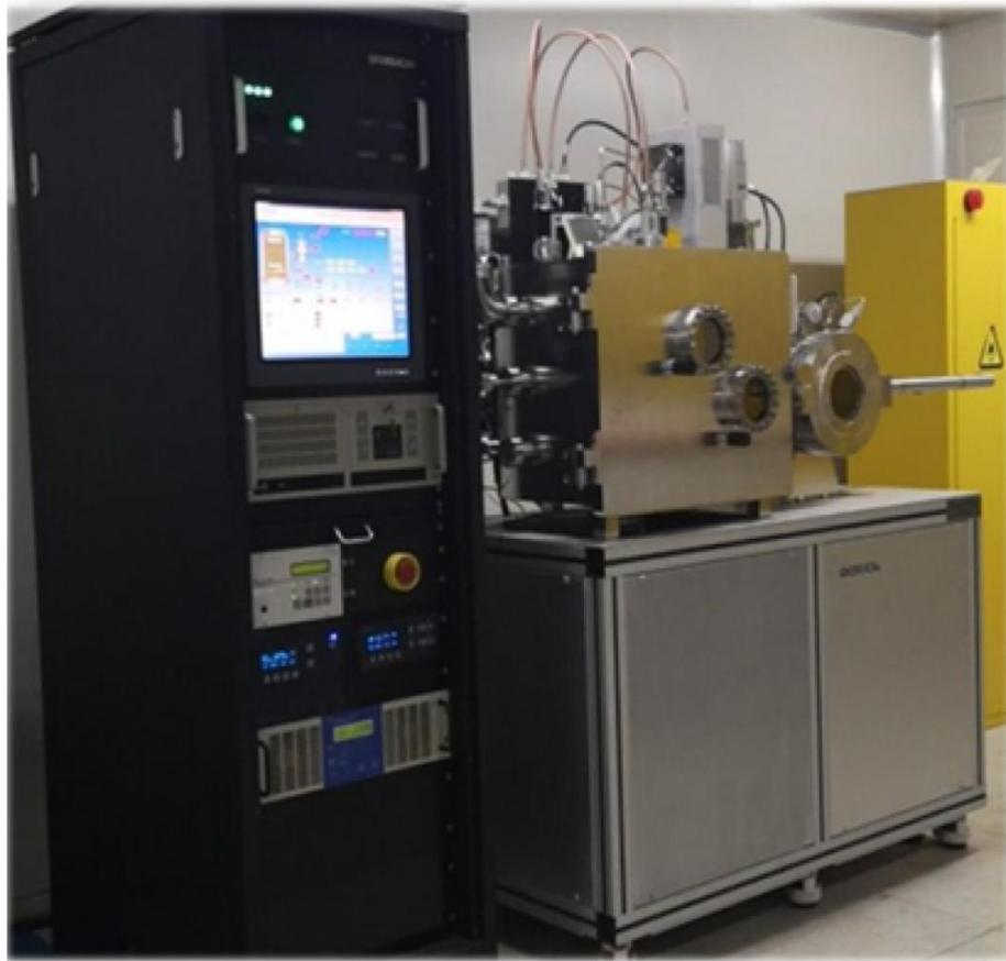
磁控溅射是物理气相沉积（Physical Vapor Deposition, PVD）的一种。一般的溅射法可被用于制备金属、半导体、绝缘体等多种材料，且具有设备简单、易于控制、镀膜面积大和附着力强等优点。
