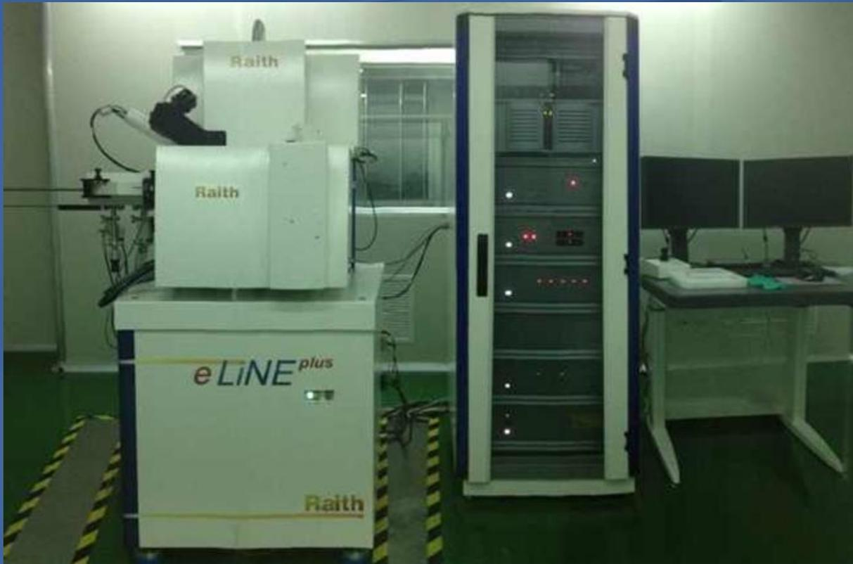
电子束曝光（electron beam lithography）指使用电子束在表面上制造图样的工艺，是光刻技术的延伸应用。电子束曝光系统（electron beam lithography system）即用于实现电子束曝光的系统。电子束曝光在半导体工业中被广泛使用于研究下一代超大规模集成电路。
