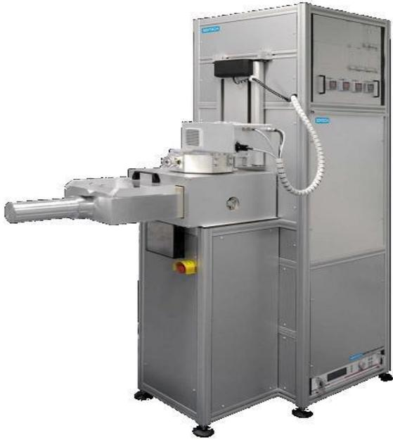
原子层沉积系统SI PEALD LL适用于小批量生产、研发、以及高校。可沉积几纳米厚的超薄膜，有出色的均匀性、对3D结构有非常好的覆盖一致性。在工艺循环中、向真空反应腔内分步骤地增加前驱体，从而精确地控制膜厚和膜特性。ALD的特性特别适合半导体工程、微机电系统MEMS和其他纳米科技的应用。
